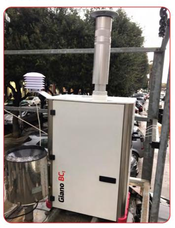
Sviluppato in collaborazione con PM\_10, spin off del dipartimento di Fisica dell'Università di Genova, **Giano** BC<sub>1</sub> integra un modulo ottico che permette di determinare in tempo reale della quantità di Black Carbon raccolta su filtro mediante la misura della componente riflessa di un fascio laser incidente sul filtro.
